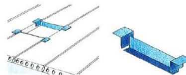
Sur commande fers d'enchevêtrement sur mesure, de 13, 16 et 17 cm de haut et d'ouverture allant de 0 à 210 cm.
