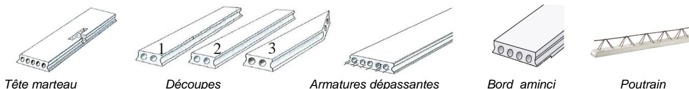
**Tête marteau :** Prévue pour assurer une liaison entre un élément de plancher et un élément porteur qui le longe. Il est possible de réaliser des «têtes marteau» dans nos hourdis lors de la production.
