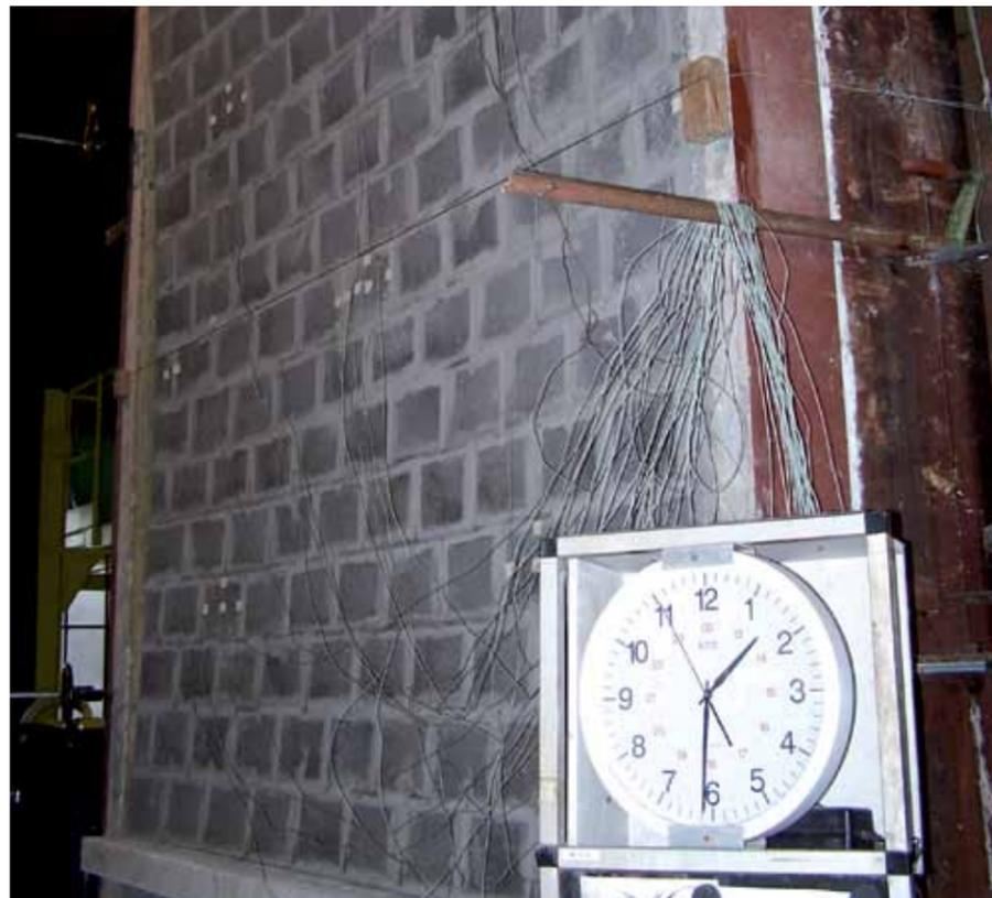
Éprouvette pour test de résistance au feu réalisé sur mur jointoyé 2 faces
