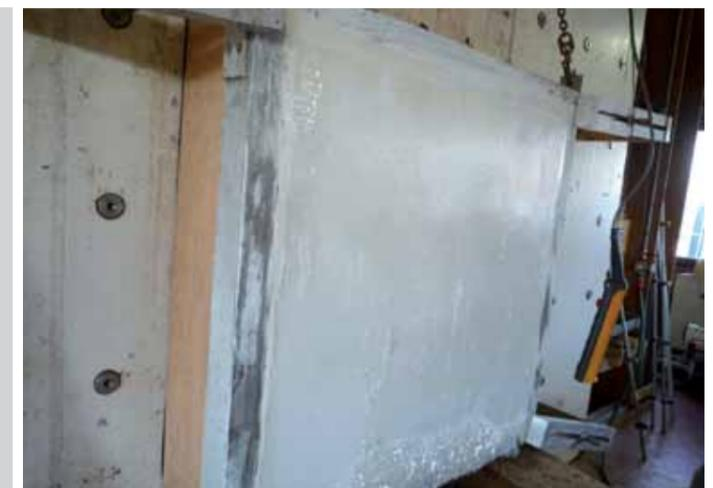
Éprouvette étanchéité à l'air
